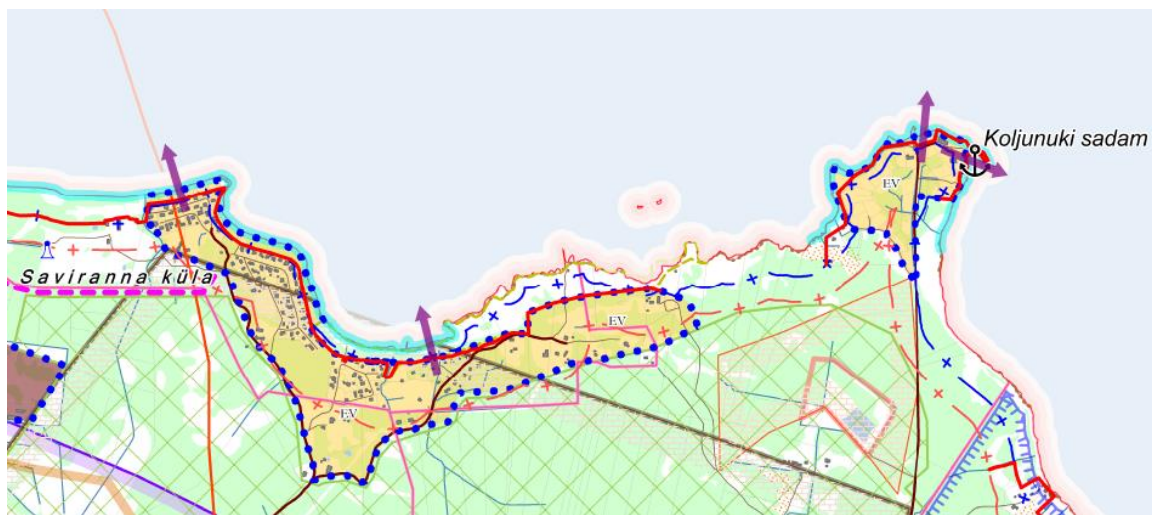
Väljavõte üldplaneeringu maakasutusplaanist Saviranna-Koljunuki piirkonnas. Ranna kindlustusrajatise vajadus on tähistatud helesinise joonega, Saviranna piirkonnas 2287m ulatuses, Koljunuki piirkonnas 1696m ulatuses.
